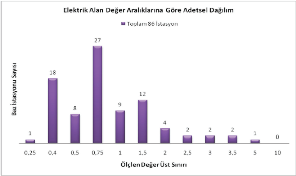
Şekil 3.4.2 Baz istasyonları elektrik alan değer aralıklarına göre adetsel dağılımı
